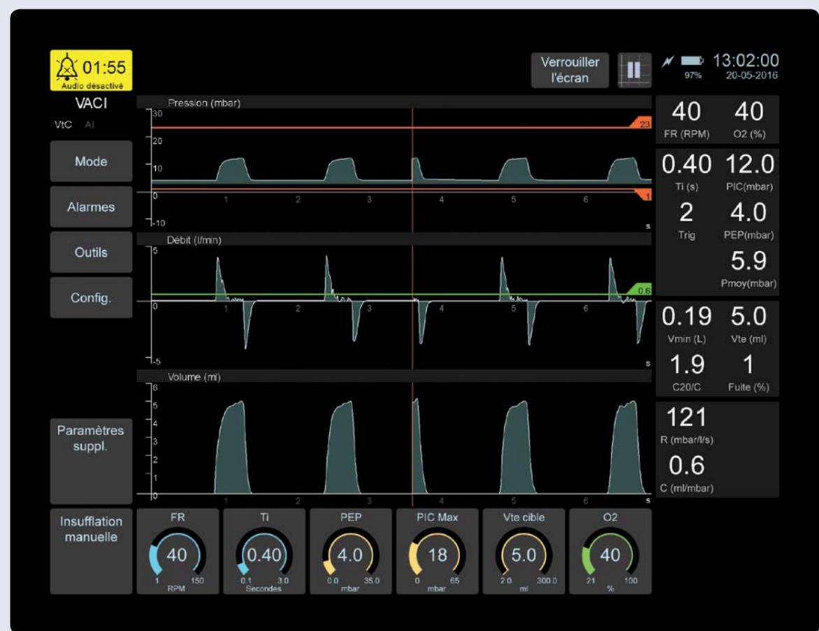
Ce ventilateur a été configuré pour montrer trois courbes de VACI. Dans cet exemple, l'alarme sonore est inhibée et le chrono dans le bouton affiche le temps restant. Par défaut, seuls les paramètres nécessaires pour contrôler la VACI sont visibles.
